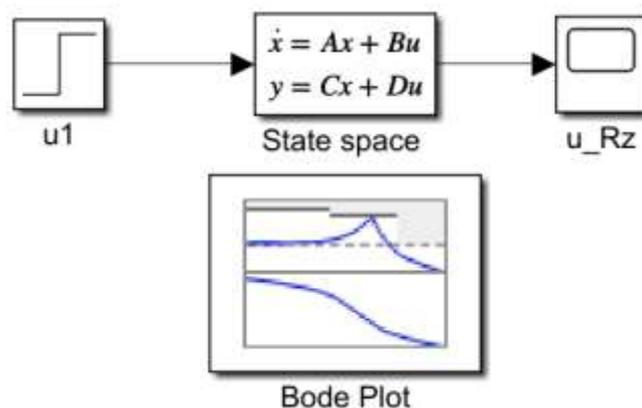
Nastavenie bloku Bode plot (treba zadeinovať vstup a výstup)
