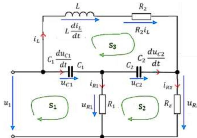
2) V schéme zostavíme slučky a v nich napät'ové rovnice:  $\sum u_i = 0$
