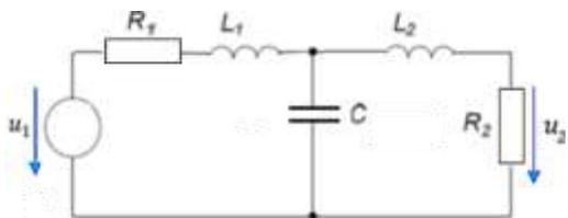
$$\begin{bmatrix} \dot{x}_1 \\ \dot{x}_2 \\ \dot{x}_3 \end{bmatrix} = \begin{bmatrix} 0 & 0 & -1/L_1 \\ 0 & -R/L_2 & 1/L_2 \\ 1/C & -1/C & 0 \end{bmatrix} \begin{bmatrix} x_1 \\ x_2 \\ x_3 \end{bmatrix} + \begin{bmatrix} 1/L_1 \\ 0 \\ 0 \end{bmatrix} u(t)$$
